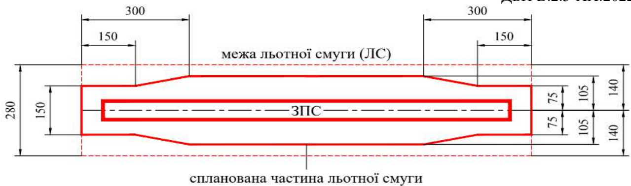
Рисунок А.4 – Спланована частина ЛС, що включає ЗПС з кодовим номером 3 або 4, обладнану для точного заходу на посадку
