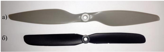
Рис. 2. Досліджувані гвинти: а) APC MR 10x4.5; б) GWS 8x4
