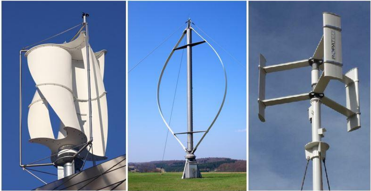
Зображення 5. а) ротор Савоніуса, б) ротор Дар'є з лопатями вигнутими по колу, в) ротор Дар'є з прямими лопатями.
