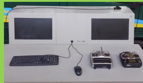
Наземна станція керування НСК М-7В5
