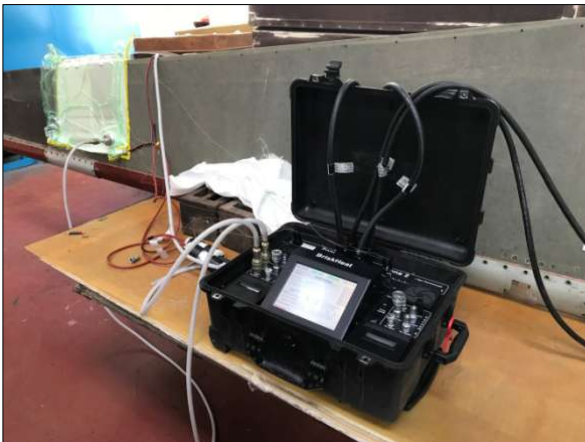
Рисунок 15 - Ремонт ушкодженої зони керма висоти літака Ан-178 с застосуванням АРК
