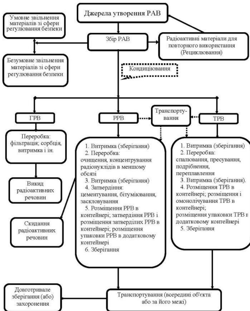
Рис. 26. Концептуальна модель системи безпечного поводження з РАВ
