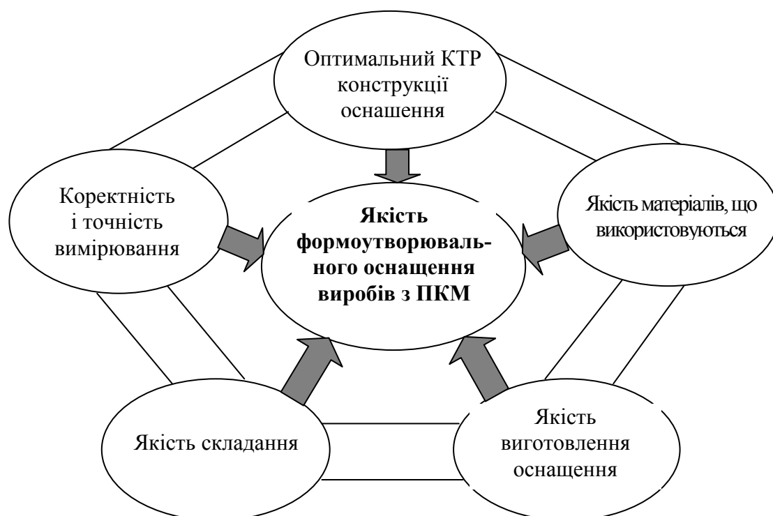
Рисунок 3.2 - Основні складові якості формоутворювального оснащення
