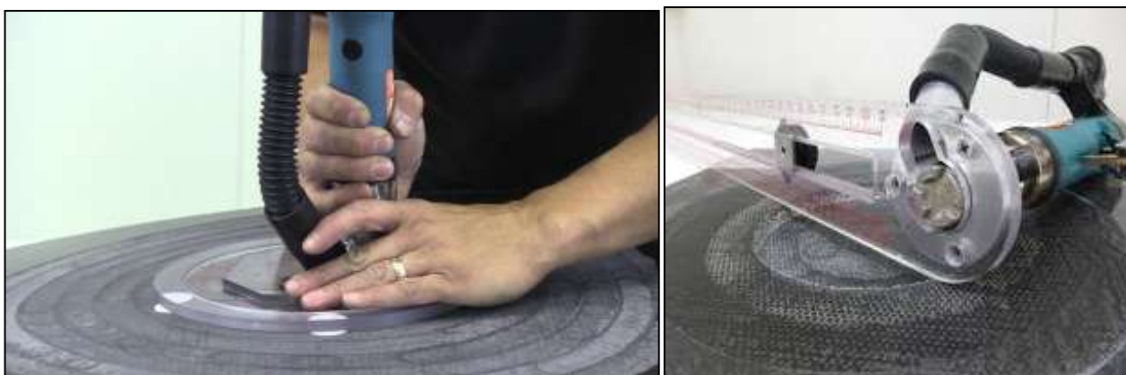
Рисунок 4.10 – Приклади пошарового видалення ушкоджених шарів
