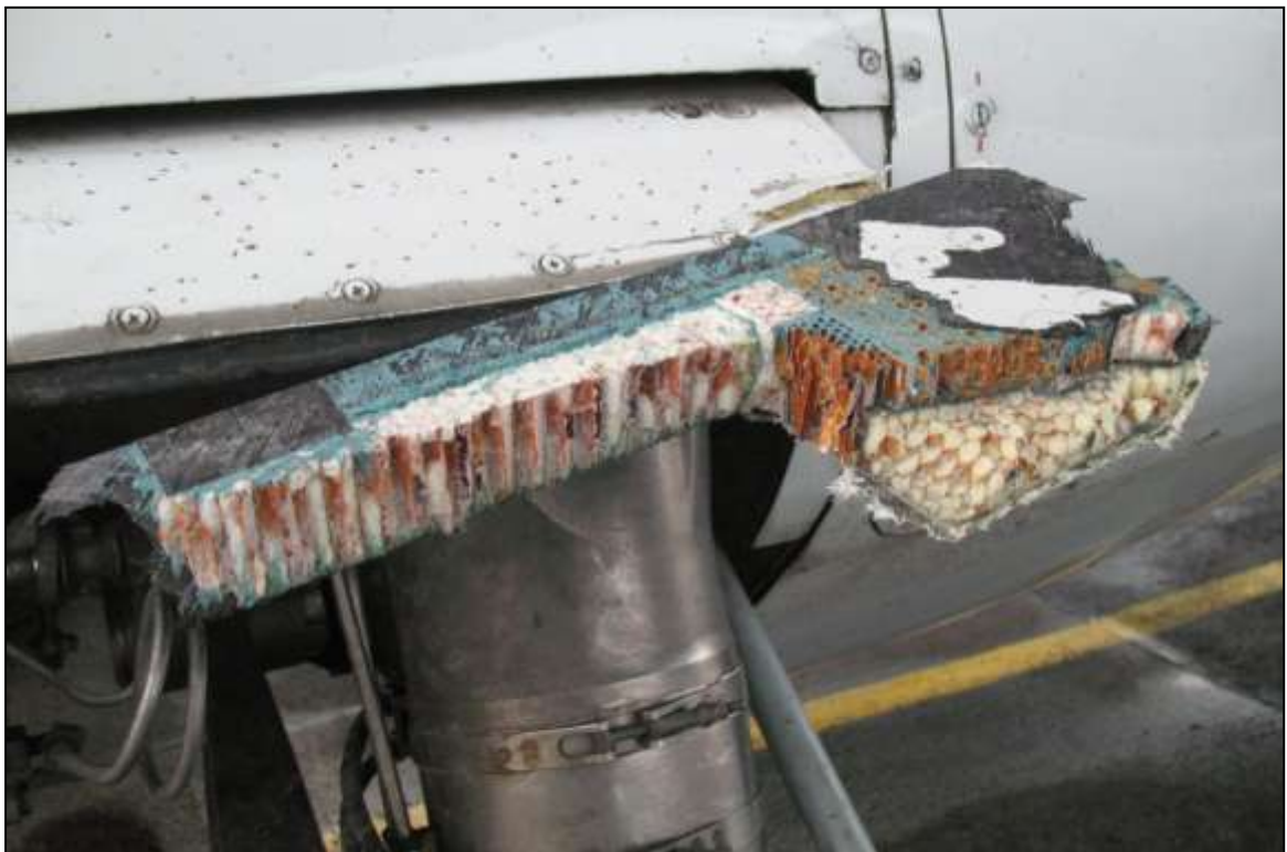
Рис. 4.6. Вирив стулки основної опори шасі літака Ан-148
