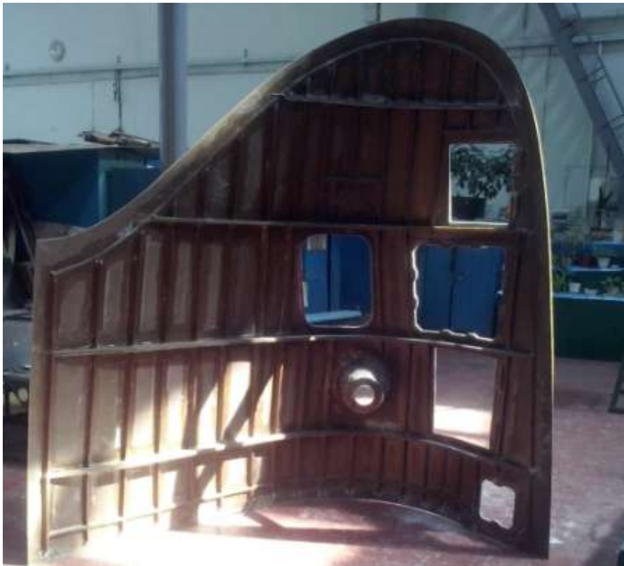
Рисунок 3.14 - Панель обтічника шасі каркасної конструкції
