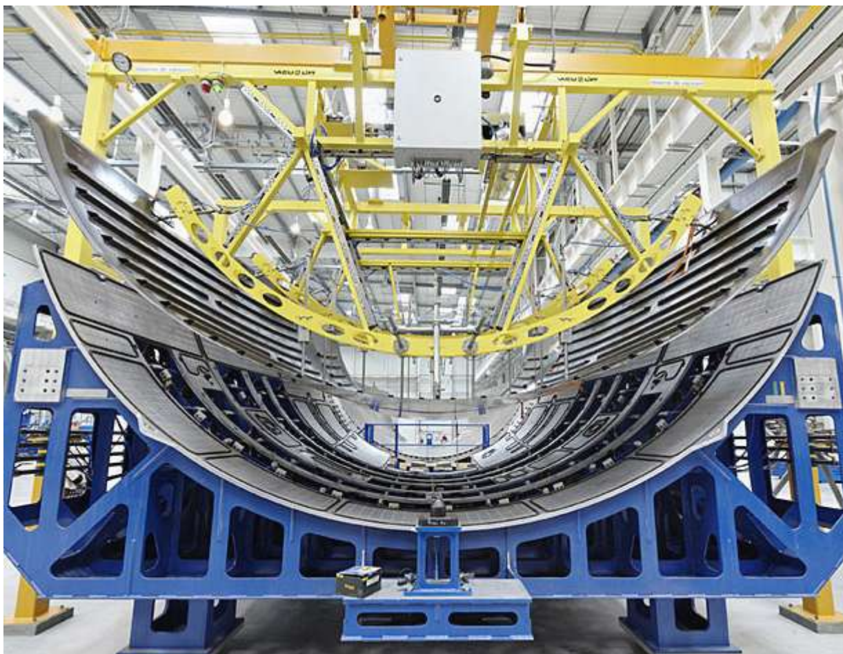
Рисунок 3.4 - Каркасне оснащення панелі фюзеляжу А-350 ХWB з ФОП з інвару.
