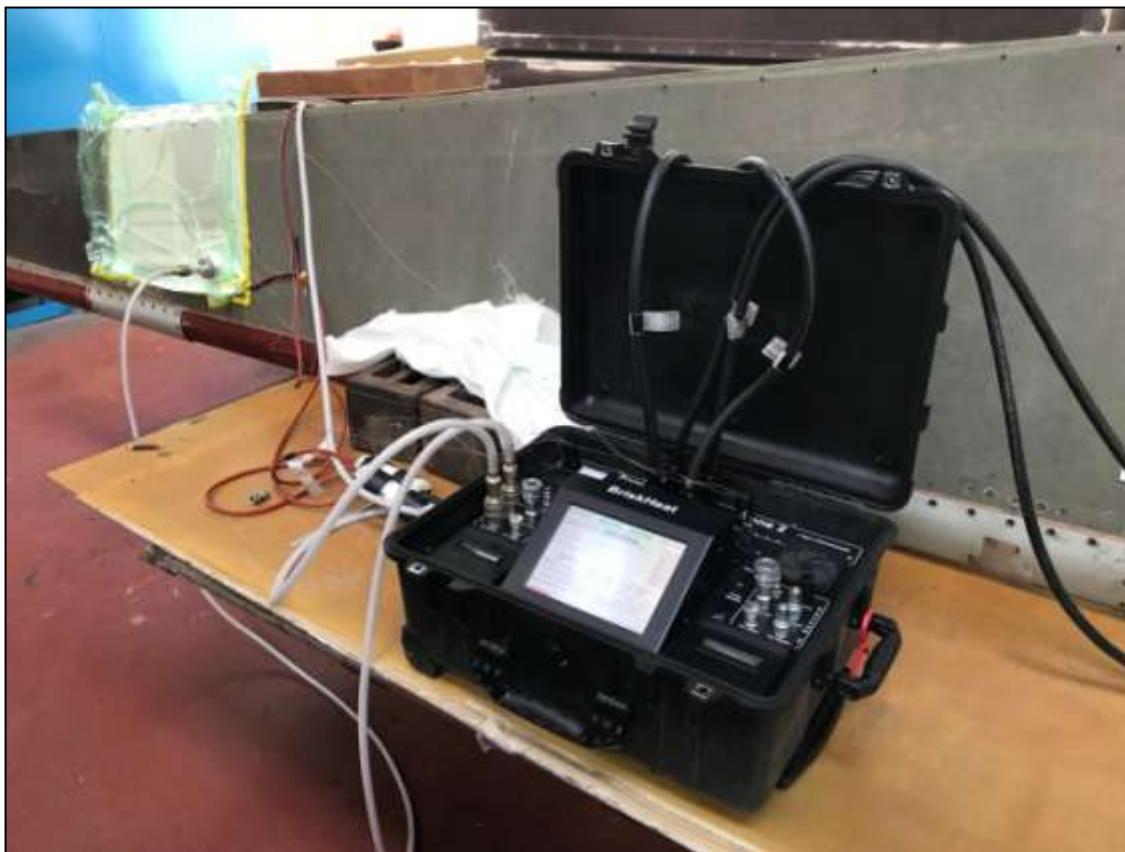
Рисунок 4.12 - Ремонт uszkodженої зони керма висоти літака Ан-178 із застосуванням АРК
