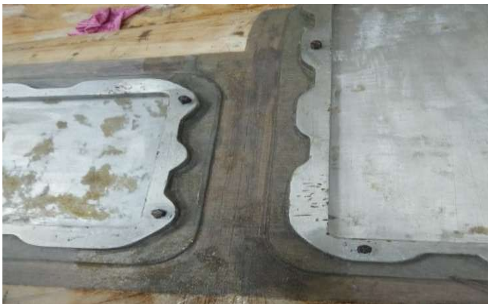
Рисунок 3.18 - Фрагмент блискавкозахисної сітки МБУ-0,08 в зоні між двома люками
