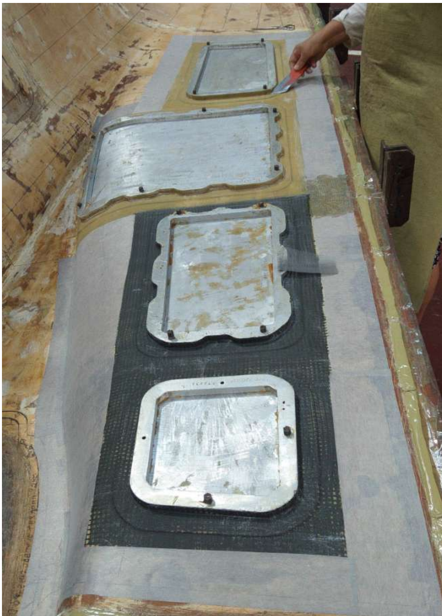
Рисунок 3.20 - Стикування плівки Syn Skin з раніше відформованими окантовками
