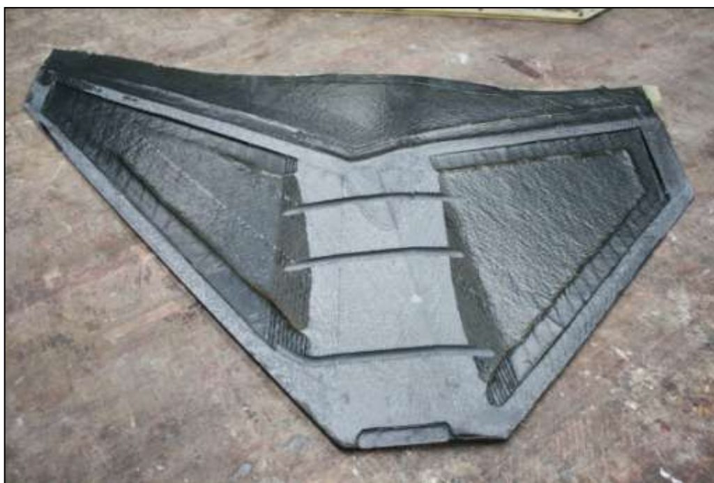
Рисунок 5.4 - Зовнішня панель КАП з вуглепластика
