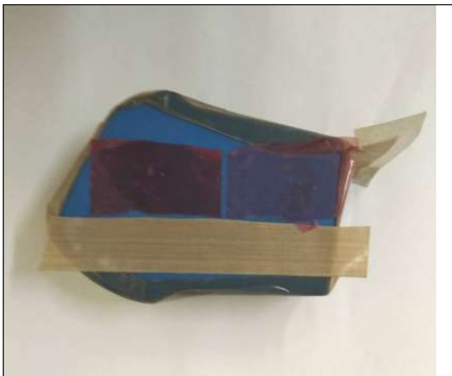
Рисунок 3.30 - Нанесення термостійких розділюючих стрічок різних марок на поверхню формуючого вкладишу із Aircast 3700
