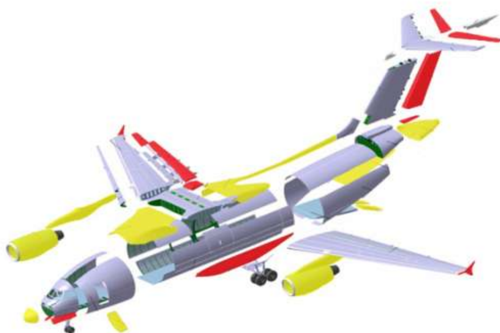
Рисунок 3.13 - Застосування ПКМ на літаку Ан-178
