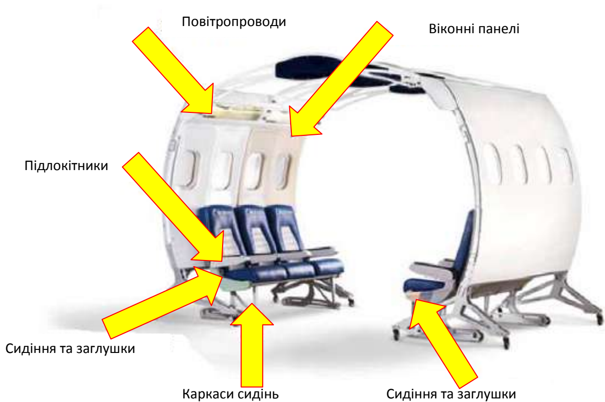
Рисунок 1.7 - Застосування 3D-друкованих деталей у літаках
