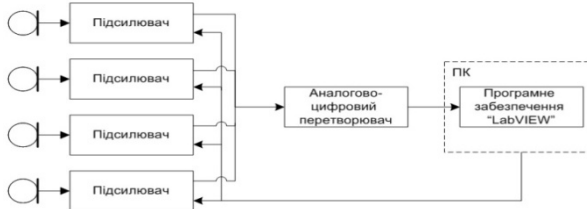
Рис. 1. Структурна схема адаптивного комплексу
